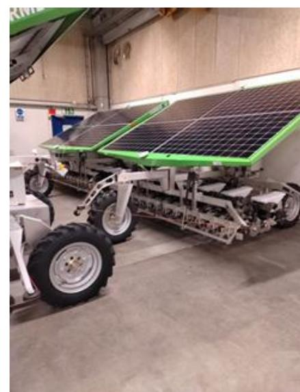
**Figur 1 og 2:** FarmDroid elektrisk drevet markrobot med solpaneler
