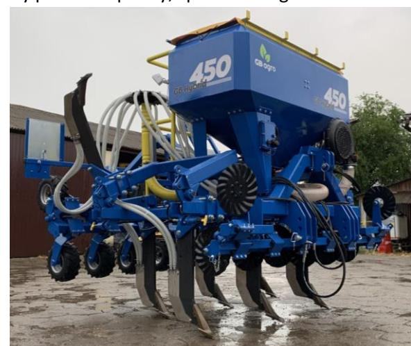
Figure 2: GH Hybrid- hybryda strip-till i głębosza
